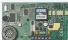
Comunicador GSM. Ligação plug-in para central I-ON40 e centrais expansíveis I-ON.
